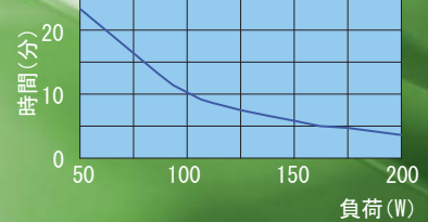
バッテリーパックアップ放電特性 (バッテリーパック使用初期の参考値であり保証値ではありませんのでご注意ください。)
