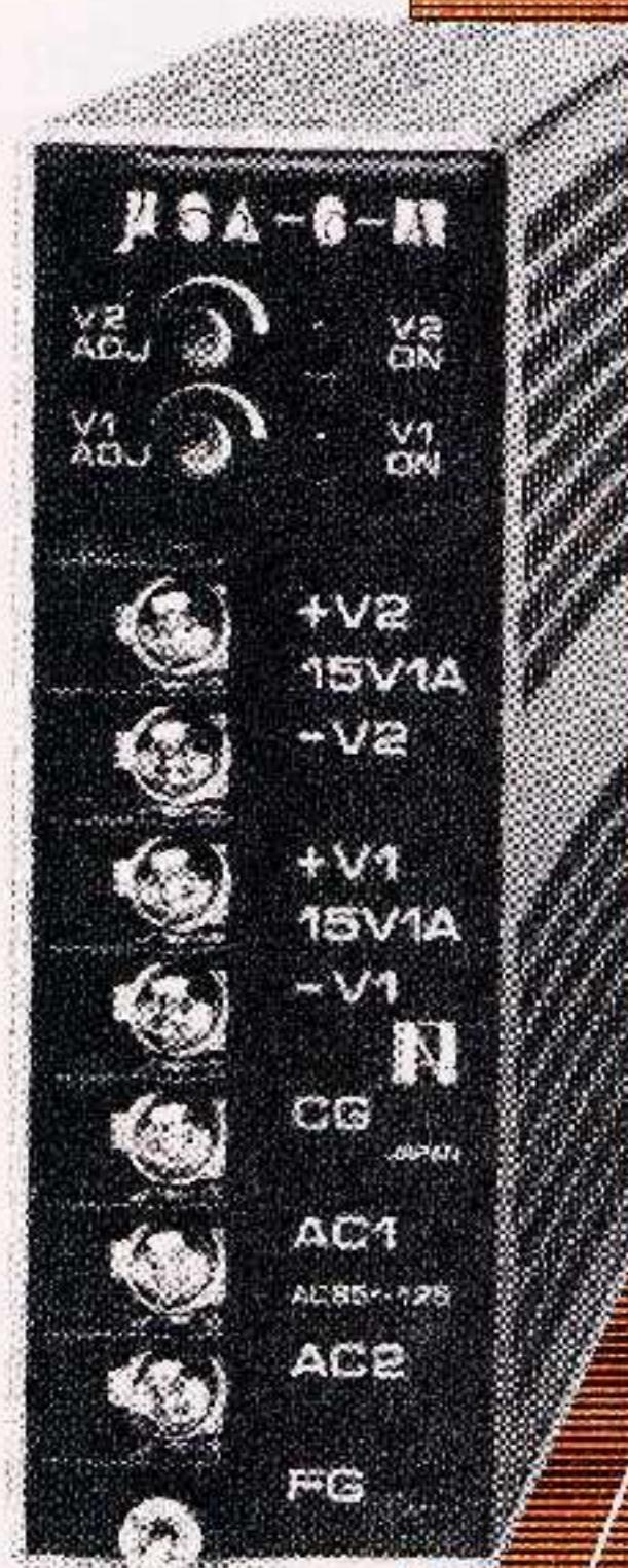
μSA6 シリーズ双出力形スイッチング電源は、一方を、スイッチング式パルス巾制御で行ない主電源とし、他方と同じトランス及びチョークコイルの 2 次側からほぼ定電圧化された出力を、ドロッパー式レギュレータで更に安定させる回路になっています。
