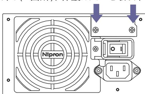
で外したネジを使用し、信号ユニットを取り付けます。
