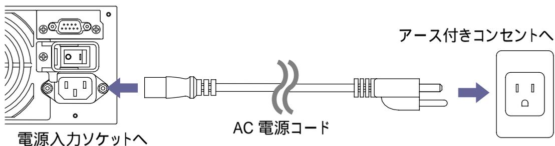
**⚠ 注意:** AC 電源コードは、電源アース線接地可能なものを使用して下さい。
