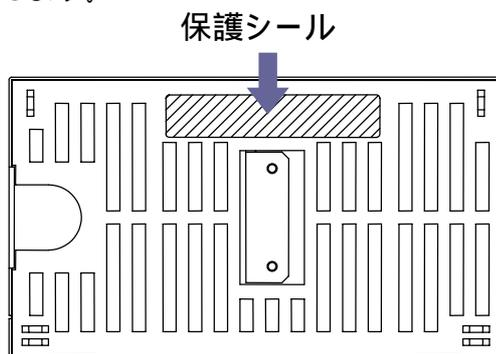
同梱のネジ2本を使用し、ノンストップユニットをコネクタの接続に注意しながら取り付け
