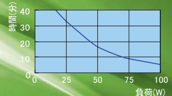
バッテリーバックアップ放電特性※
