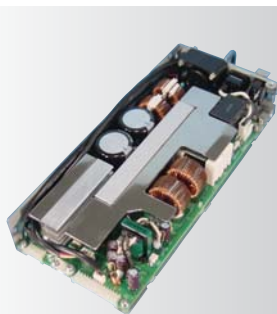
プライマリー・ユニット内部写真
