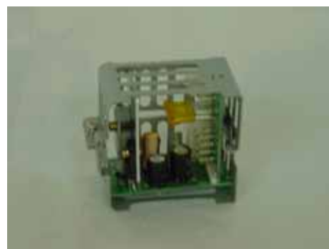
写真 5.6 鉛バッテリーチャージャー
