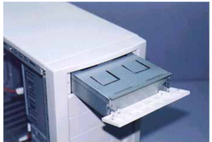
写真 5.4 リムーバブルバッテリーホットスワップ時
