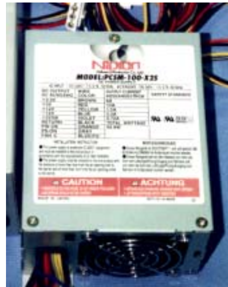
写真 2.7 出力と線の色に対応は銘板シールを確認する。各出力が出力可能な電流容量が明記されているものもある。
