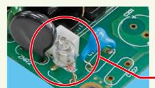
サージ保護素子としてアレスタを搭載し、雷などの 外来入力サージに対する耐量を強化しています。
