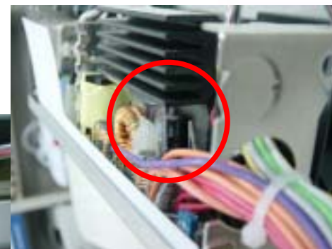
電解コンデンサの破裂 部品不良および設計不良が原因
