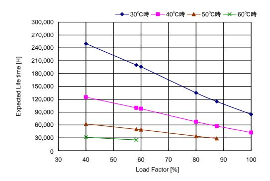
Over the area of 15 years, the degradation of sealing rubber, etc., is not included in the calculation (15年以上では、封口ゴムの劣化の影響は、計算式には含まれていません)
