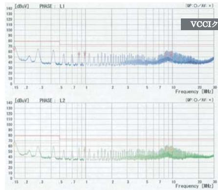
●図8 雑音端子電圧特性 (AC240V時)
