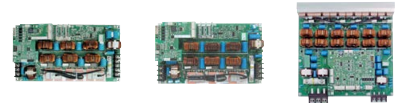
MPPT制御機能搭載 非絶縁型 電解コンデンサ&ファンレス昇圧電源
